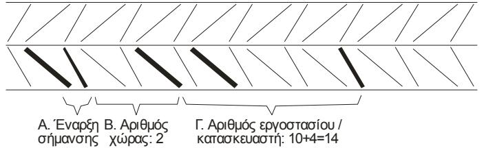
**Σχήμα 2-4** Παράδειγμα σήμανσης για την αναγνώριση της χώρας και της μονάδας παραγωγής χάλυβα κατηγορίας B500C
